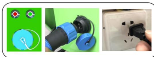
**Hinweis!** Laden Sie die Batterie sofort auf, wenn die Spannungsanzeige auf dem Armaturenbrett unter 44 V fällt.
